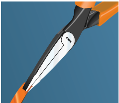
Platbektangen Worden gebruikt voor assembleerwerk
