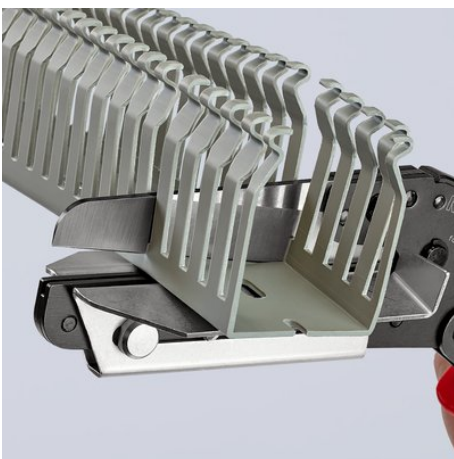
Longueur de la lame 110 mm pour sectionner les goulottes de câbles larges
