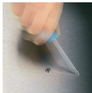
Keer op keer gebeurt het dat je bij het schroeven uit de schroef glijdt. Soms worden waardevolle oppervlakten beschadigd of is letsel het gevolg. De punt van de Wera Lasertip-schroevendraaier wordt met de laser microscopisch fijn opgeruwd. Deze microruwe oppervlakte bijt zich in de schroevenkop vast. Het uitglijden uit de schroef behoort tot het verleden!
