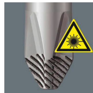
Door een gebundelde laserstraal wordt er een scherpe oppervlaktestructuur ingebrand. Wera Lasertip bijt zich in de schroefkop vast en voorkomt het wegglijden uit de Sleuf-, Phillips- en Pozidrivschroefkop.
