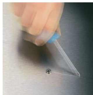
Keer op keer gebeurt het dat je bij het schroeven uit de schroef glijdt. Soms worden waardevolle oppervlakten beschadigd of is letsel het gevolg. De punt van de Wera Lasertip-schroevendraaier wordt met de laser microscopisch fijn opgeruwd. Deze microuwe oppervlakte bijt zich in de schroevenkop vast. Het uitglijden uit de schroef behoort tot het verleden!
